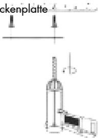
2. Befestigen Sie die Deckenplatte an der Decke
