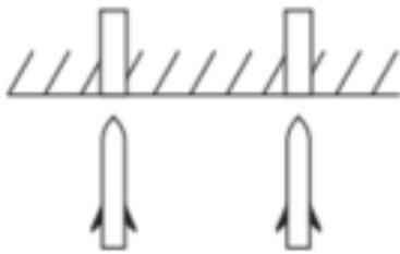
1. Verwenden Sie einen Bohrer, um zwei Löcher in die Decke zu bohren. Richten Sie die Löcher mit den Löchern der Lochplatten aus und schlagen Sie sie dann mit Dehnschrauben in die Wand.
