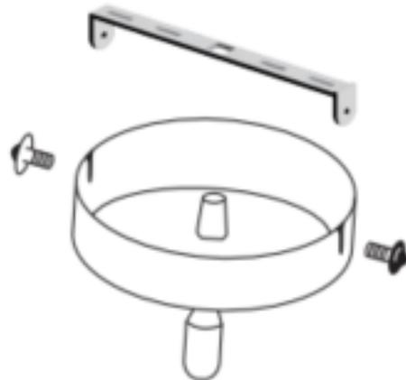
4. Verwenden Sie die kleinen Schrauben aus dem Kit an der Seite der Sitzplatte, um das Chassis und die Aufhängeplatte zu befestigen.
