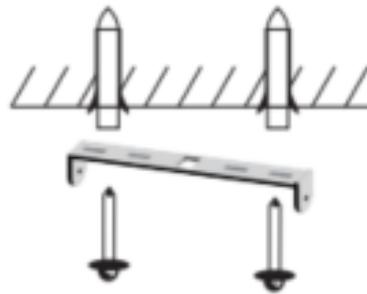
2. Verwenden Sie Schrauben, um die Steckplatte im Bausatz zu befestigen.
