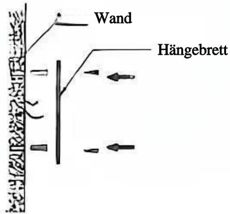
1. Installationsanleitung für das Hängebrett: die passende Größe des "Pilotlochs" in der Installationsposition entsprechend dem Abstand zwischen den Löchern des Hängebretts bohren, und dann den Gummistopfen in das Loch stecken, die Verwendung von selbstschneidenden Schrauben, um das Hängebrett in der Mehlahonn iton zu befestigen
