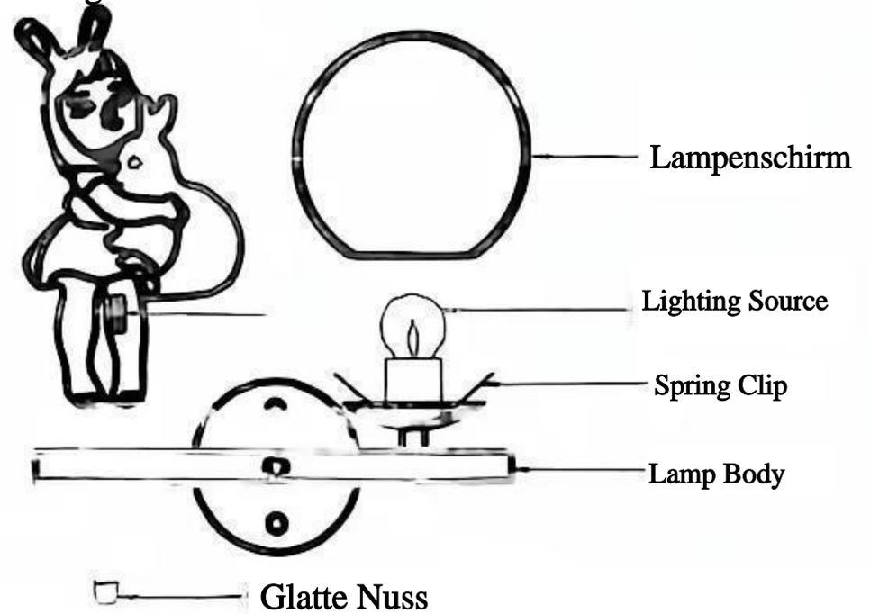
3. Befestigen Sie die Puppeneinheit mit der glatten Mutter an der Lampenhalterung, wie in der Abbildung gezeigt. Stellen Sie die Lichtquelle und die Lampe auf und sichern Sie sie schließlich mit der Federklemme.
