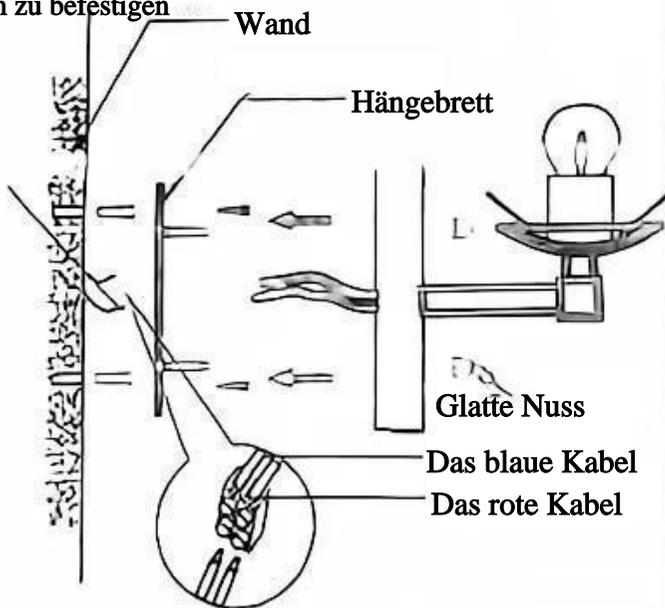
2. schließen Sie die Hauptleitung der Lampe an die Hauptleitung an, wie in der Abbildung gezeigt, richten Sie dann das Gehäuse der Wandlampe mit dem Loch aus und sichern Sie es mit der Mutter.
