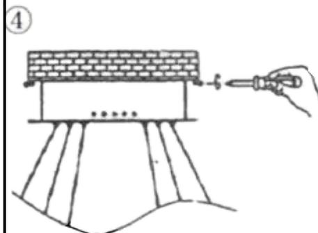
4. Platzieren Sie die Deckenplatte an der Decke, richten Sie die seitlichen Löcher der Saugvorbereitungsplatte mit den Löchern der Querkreuzplatte aus, schrauben Sie die Rundkopfschrauben in die Schraubenlöcher der Lochplatte mit einem Schraubendreher ein und verriegeln Sie sie.
