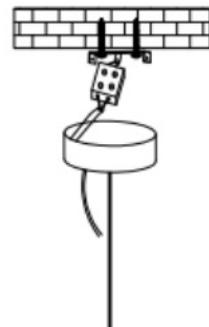
Das Stromkabel und der Lampendraht sind verbunden, und die Verbindung muss fest sein, keine falsche Verbindung
