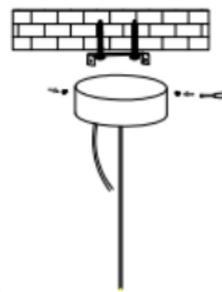
Setzen Sie den Draht und das Terminal in die Deckenschale und verbinden Sie die Deckenschale und die hängende Platte mit Schrauben
