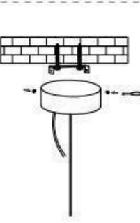
Stecken Sie den Draht und den Anschluss in die Deckenhalterung und verbinden Sie die Deckenhalterung und die Aufhängeplatte mit Schrauben
