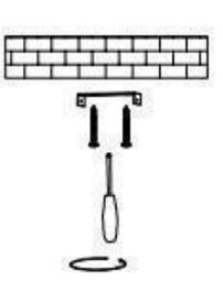
Befestigen Sie die Aufhängeplatte mit Schrauben an der Decke
