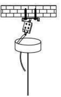
Das Netzkabel und das Lampenkabel sind verbunden, und die Verbindung muss fest sein, keine falsche Verbindung
