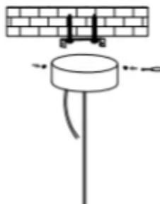
Stecken Sie das Kabel und die Klemme in den Deckenbecher und verbinden Sie den Deckenbecher und die Aufhängeplatte mit Schrauben.
