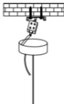
Das Netzkabel und der Überlappungsdraht sind verbunden, und die Verbindung muss fest sein, um nicht falsch angeschlossen zu werden.
