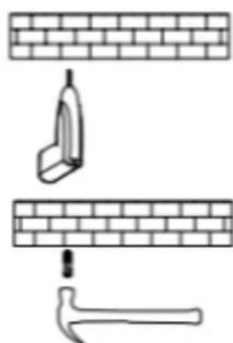
1: Bohren Sie die Installationslöcher entsprechend der Decke der Aufhängeplatte.
