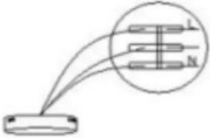
2. Verbinden Sie die Haushaltsstromversorgung von AC110V-AC240V.
