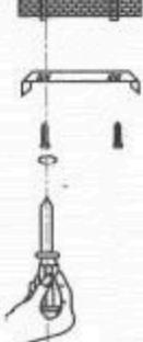
Befestigen Sie die Aufhängeplatte mit selbstschneidenden Schrauben.
