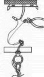
Verbinden Sie den Plus- und Minuspol des Lampenkabels jeweils mit dem entsprechenden Raumkabel. Anschließend die Kabel verbinden und mit Lüsterklemmen oder Verbindungskappen fixieren.
