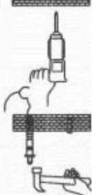
1. Bohren Sie Löcher an der Montagestelle entsprechend der Lochposition der Aufhängeplatte.
