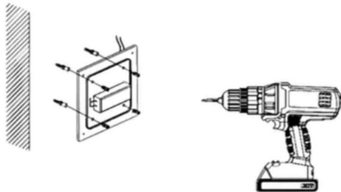
3. Bohren Sie zwei Löcher in die Wand und setzen Sie die 2 Kunststoffschrauben in diese beiden Löcher ein, dann befestigen Sie den Sockel der Lampe mit den 2 Schrauben aus dem Zubehörpaket an der Wand.
