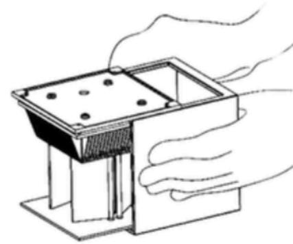
1. Entfernen Sie die äußere Abdeckung vom Hauptgehäuse der Wandleuchte.
