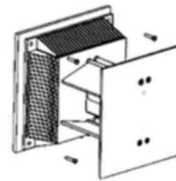
2. Verwenden Sie den kleinen Inbusschlüssel, um den Sockel der Lampe vom Hauptgehäuse zu entfernen.
