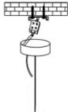
Das Netzkabel und das Lampenkabel sind verbunden, und die Verbindung muss fest sein, keine falsche Verbindung.
