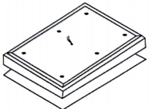
6. Setzen Sie den Diffusor auf den Lampenkörper.
