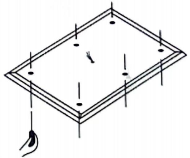
4. Befestigen Sie die Aufhängeplatte mit Schrauben an den Schaumstoffteilchen.
