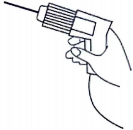
2. Mit einem 6-mm-Bohrer Löcher an den Markierungen bohren.
